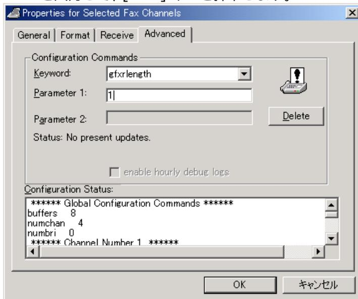
4. 「Configuration Status:」ウィンドウをスクロールし、各チャンネル・ナンバーのセクションにて **gfxrlength** が **1** になっていることを確認して下さい。
