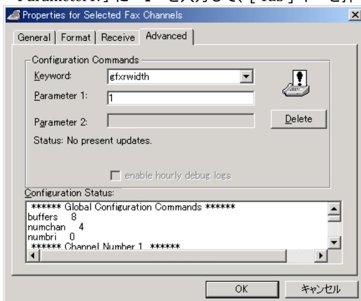
6. 「Configuration Status:」ウィンドウをスクロールし、各チャンネル・ナンバーのセクションにて **gfxrwidth** が **1** になっていることを確認して下さい。
